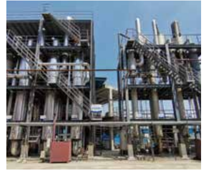
韶关鹏瑞环保科技有限公司 氯化铵废水：6t/h 三效蒸发器(1套)+ 10t/h三效蒸发器(1套)+15t/h三效蒸发器(1套)
