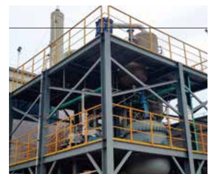
江西新余木林森光电科技有限公司 电镀废水 1t/h MVR 蒸发器 (1套)
