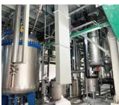
江门市崖门新财富环保工业有限公司 物化废水，焚烧废水 6t/h三效蒸发器（2套）+ 6t/h双效蒸发器（1套）
