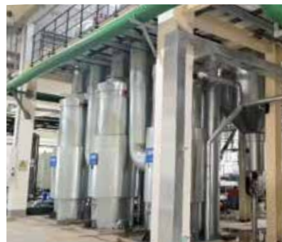
中化环境科技工程有限公司 物化废水，焚烧废水 15t/h MVR 蒸发器(1套)+15t/h 三效蒸发器(1套)
