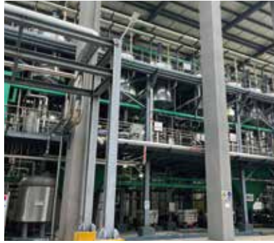
黄冈TCL环境科技有限公司 物化废水： 4t/h三效蒸发器 (2套)
