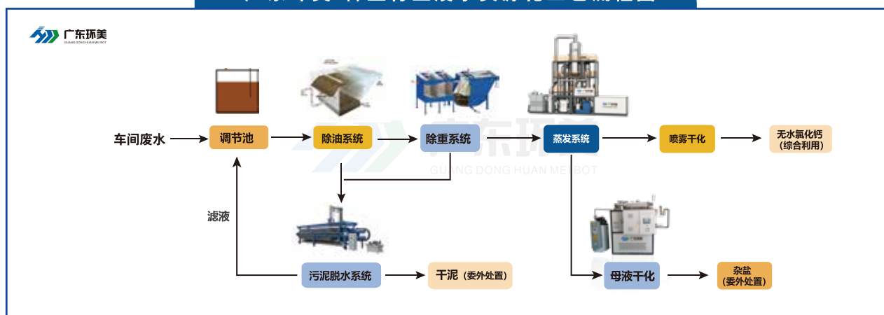
广东环美-稀土行业废水资源化工艺流程图
