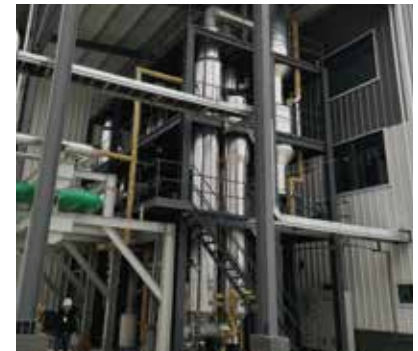
时代思康新材料有限公司 氟化锂浓缩项目 12t/h MVR 蒸发器 (2套)
