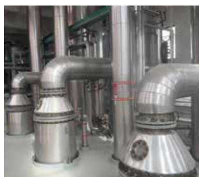
深圳冠融辰环保科技有限公司 硝酸钠/磷酸钠废水 4t/h三效蒸发器(1套)+6t/h三效蒸发器(1套)
