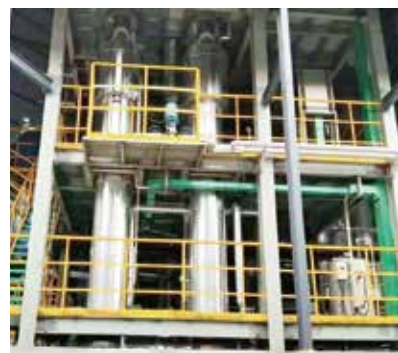
梅州侨韵环保科技有限公司 氯化铵蒸发结晶 6t/h MVR 蒸发器(1套)+3.5t/h双效蒸发器(1套)
