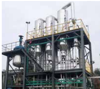
广东长盈精密技术有限公司 阳极氧化废水 6t/h三效蒸发器 (1套)
