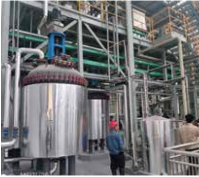
广东金宇环境科技股份有限公司 铷稀有金属资源化项目： 4t/h MVR蒸发器+单釜(1套)
