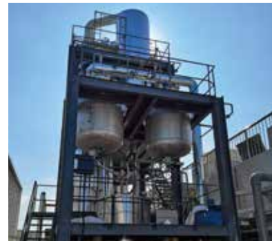
东莞蓝思科技有限公司 阳极氧化废水 4t/h三效蒸发器 (1套)
