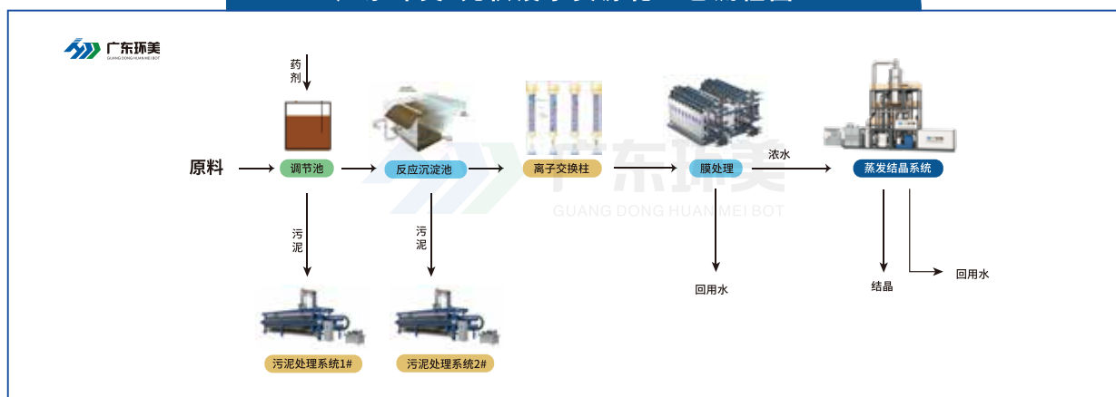
广东环美-光伏废水资源化工艺流程图
