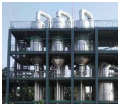
广州国宏新材料有限公司（久泰集团） 合成纤维单体/聚合体制造 30t/h 三效+单效蒸发系统
