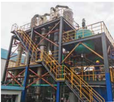
英德市茂鑫生物环能科技实业有限公司 物化废水 2t/h三效蒸发器（1套）
