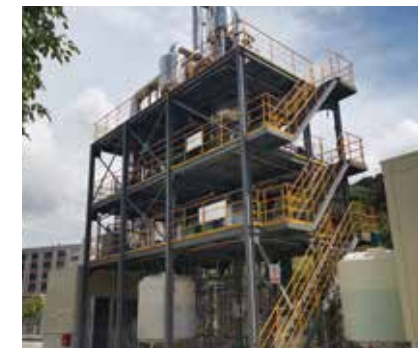
萍乡塑业科技有限公司 工业废水 2t/h MVR 蒸发器 (1套)
