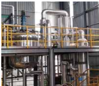
四川某石油压裂返排液项目 13t/h的MVR蒸发系统（2套）+配套5t的双效+母液干化蒸发系统
