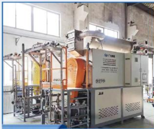
采用真空蒸馏技术 减量结晶 占地面积小，经济效益高 刮板式蒸发器
