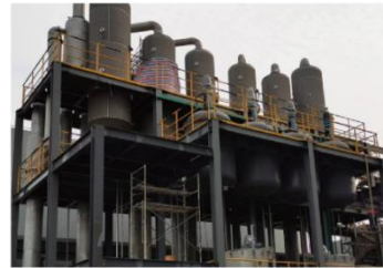
深圳冠融辰环保科技有限公司 硝酸钠/磷酸钠废水 4T/H三效蒸发器 1套+6T/H三效蒸发器 1套
