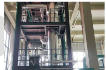
梅州侨韵环保科技有限公司 氯化铵蒸发结晶 6T/H MVR 蒸发器 1套、3.5T/H双效蒸发器 1套
