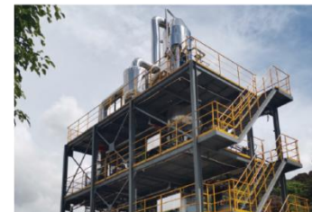
萍乡塑业科技有限公司 工业废水 2T/H MVR 蒸发器 1套
