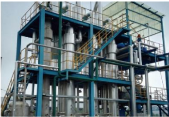
英德市茂鑫生物能科技实业有限公司 物化废水 2T/H三效蒸发器 1套
