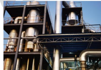
肇庆焕发生物科技有限公司 糖浆浓缩项目 10T/H MVR蒸发系统
