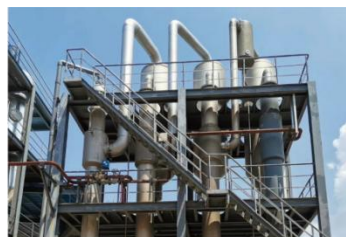
韶关鹏瑞环保科技有限公司 氯化铵废水: 6T/H 三效蒸发器 1套+ 10T/H三效蒸发器 1套+15T/H三效蒸发器 1套
